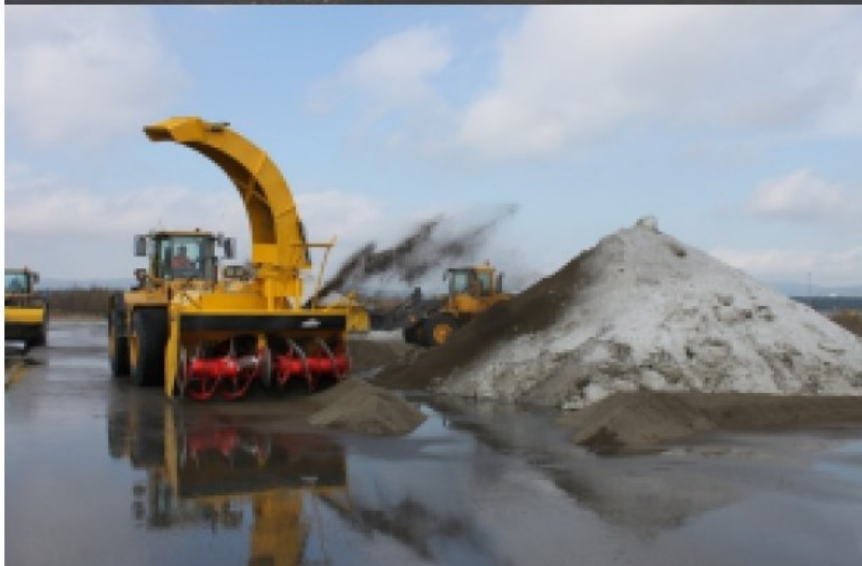
Figur 1 Oppstilling av snødeponi for testforsøk.
